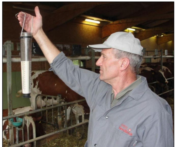
Die Milchmenge wird vom senkrecht stehenden oder hängenden Messzylinder auf 100 Gramm genau abgelesen (Achtung: Eichung auf 200 g) und sofort auf dem Begleitschein eingetragen.
